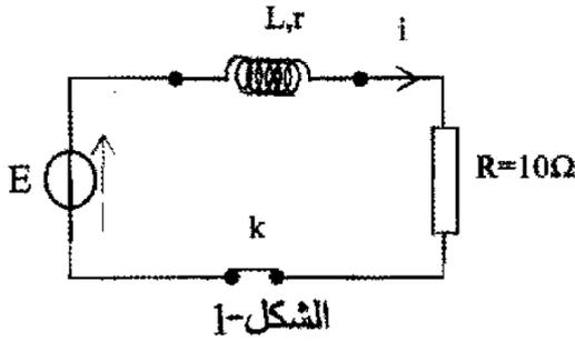
نريد تعيين  $(L, r)$  مميزتي وشيعة نربطها في دارة كهربائية على التسلسل مع : مولد كهربائي ذي توتر ثابت  $E = 6V$  ، ناقل أومي مقاومته  $R = 10 \Omega$  ، قاطعة  $k$  (الشكل-1) .
