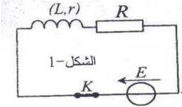
بهدف تعيين الثابتين  $(L, r)$  المميزين لوشيعة ، نحقق الدارة الكهربائية (الشكل-1) ، حيث :  $E = 9V$  و  $R = 45 \Omega$  في اللحظة  $t = 0$  s نغلق القاطعة  $K$  .
